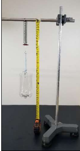
Figura 5. Montaje experimental, sistema botella plástica con resorte y cinta métrica.
