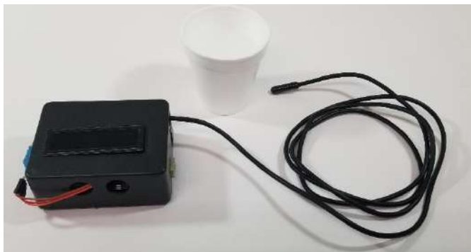
Figura 1. Instrumento de medición con sensor de temperatura ambiental (DHT11) y sensor de temperatura para agua cercana a 100°C (DS18B20) basado en placa Arduino UNO.
